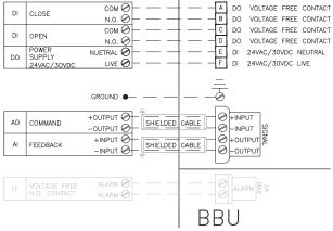
24VAC/VDC SERVO NXT WITH BBU
